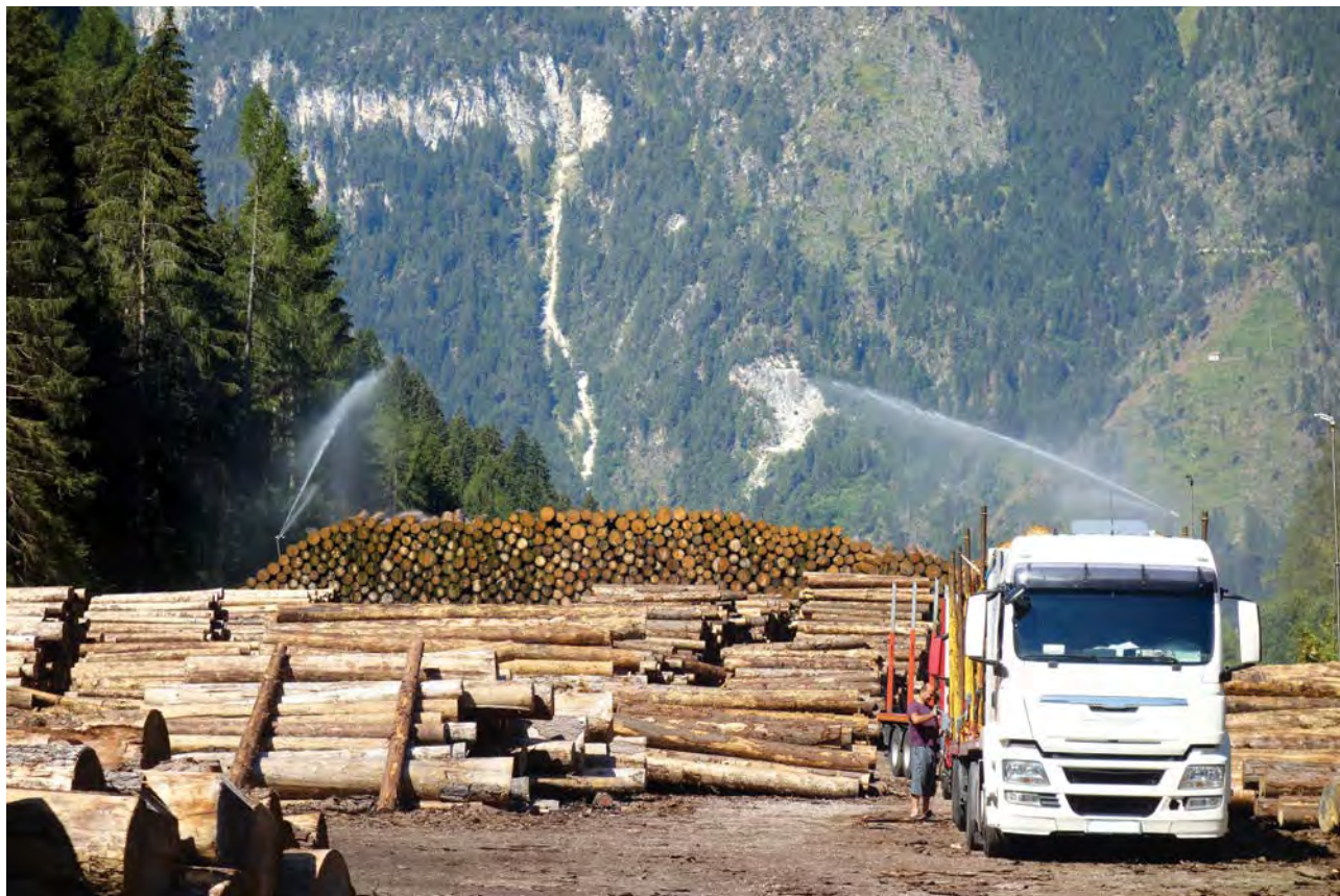
FOTO 3.19 - Piazzale strategico irrigato realizzato nei pressi dell'abitato di Predazzo
