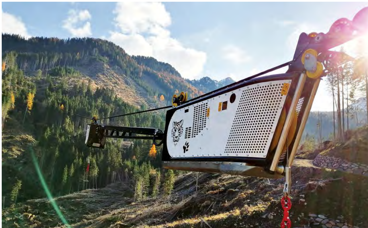
FOTO 4.6 - Carrello motorizzato per gru a cavo dotato di carrello ausiliario per l'esbosco a pianta intera finanziato mediante PSR, loc. Val Cavelonte
